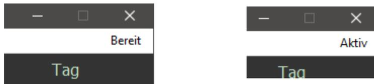
Ist eine Zentraluhr nicht "Aktiv" aber "Bereit", kann sie trotzdem alle zentralen Start- und Stoppbefehle auslösen. Sie werden selbsttätig von der aktiven Uhr ausgeführt.
