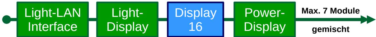
Das Display-16lite Modul kann in beliebiger Reihenfolge mit den Light-Display-Modulen gemischt werden. Die Typen und Reihenfolge der Module sind in der Software unter 'Optionen' und 'Lichtmodule' anzugeben.
