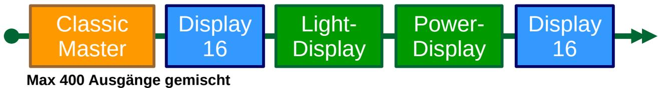
Die Ausgänge aller S-Bus Module werden per Light@Night Software nach Minus ein- oder ausgeschaltet und dadurch mit dem Minuspol der 12 Volt Spannung verbunden. Die gewünschten Effekte werden per Software erzeugt, soweit dies überhaupt möglich ist. Dies ist auch beim Display 16 lite so.
