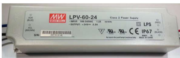
24V Schaltnetzteil für analoge LED
