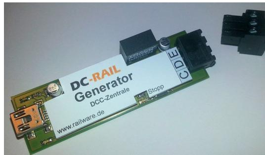
Er wird per USB-Anschluss mit dem Light@Night PC verbunden und ist nach wenigen Sekunden betriebsbereit. Am Ausgang benötigt er noch einen handelsüblichen Booster mit „CDE“ Eingang. Diesen Anschluss besitzt nahezu jeder auch für DCC geeignete Booster.
