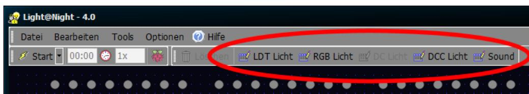
Die Lichtpunkte sind fest in Reihen aufgeteilt. Jede Reihe hat 40 Lichtpunkte, die in 5 Gruppen mit 8 Lichtpunkten unterteilt sind. Das entspricht einem Light-Display von LDT.
